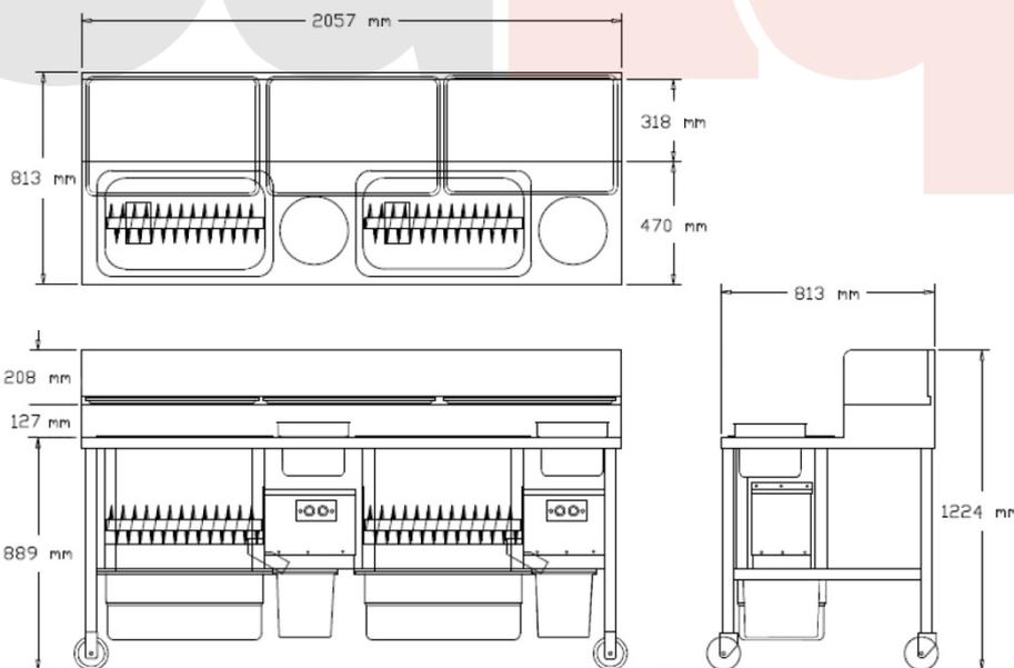
**Электрические характеристики:** 2 отдельных подключения по 230 В, 1 фаза, 50 Гц, 0,9 А, 207 Ватт
